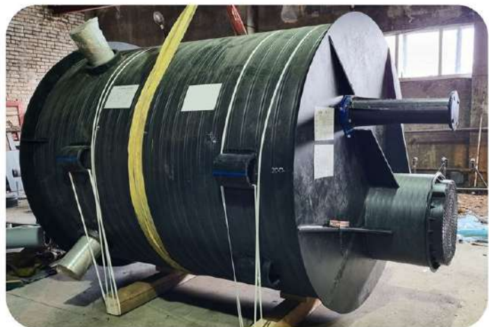
Колодец для канализации механически загрязненных вод ID 2000 x H 2630 мм + горловина ID 700 x H 500 мм, патрубки сталь 219 мм
