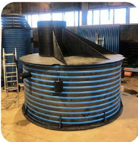
Канализационный колодец ID 2400 x H 1200 мм горловина ID 800 x H 900 мм
